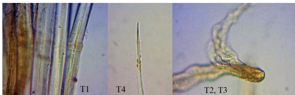
Fig. 11. Riconoscimento delle fibre; T1, T4: fibre di Lino; T2, T3: fibre di canapa.
